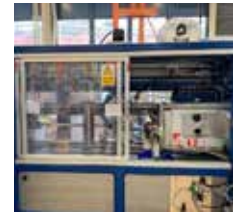
A350 TRAS actuator test rig
